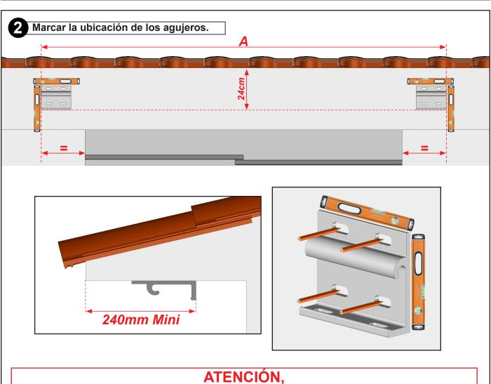
Una alineación incorrecta de los Soportes o una instalación incorrecta pueden provocar la caída del Toldo. No asumimos ninguna responsabilidad por los daños materiales y/o personales causados por una instalación incorrecta.
