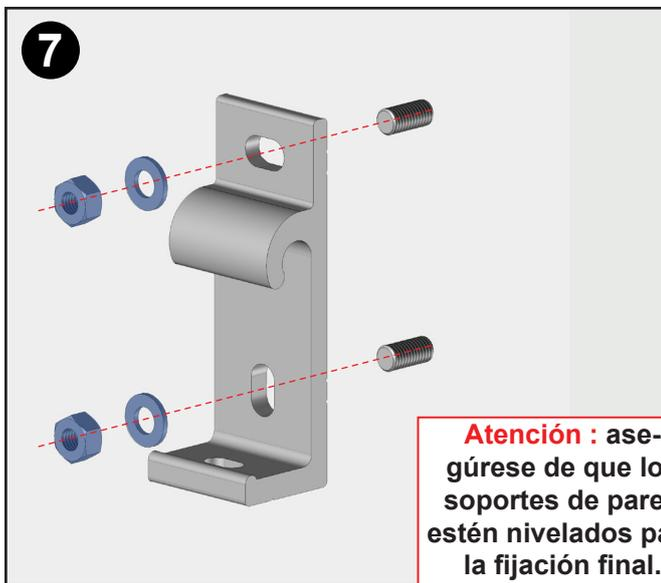
**Atención :** asegúrese de que los soportes de pared estén nivelados para la fijación final.
