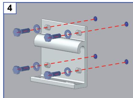
Fixation avec des vis Ø10mm. Kit de vis, cheville et rondelle non fournis.
