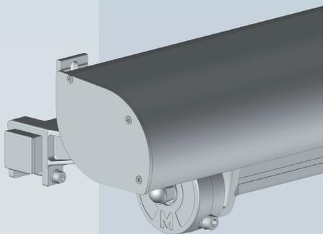
Store fermer, la barre de charge (PU100) recouvre le tube d'enroulement.
