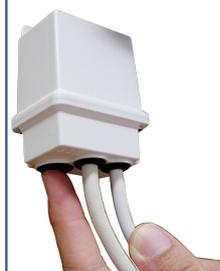
Ne pas enlever la protection d'étanchéité (bouchon noir) pour actionner le bouton SEL. Appuyer directement.
