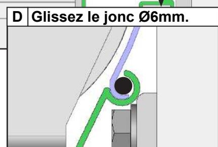
**28 Étanchéité du capot de finition.**
