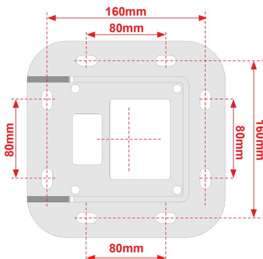
Fixez les platines au niveau de chaque plot béton réalisé. Utilisez un nombre de vis égal au nombre de trous de fixation présents sur la platine.
