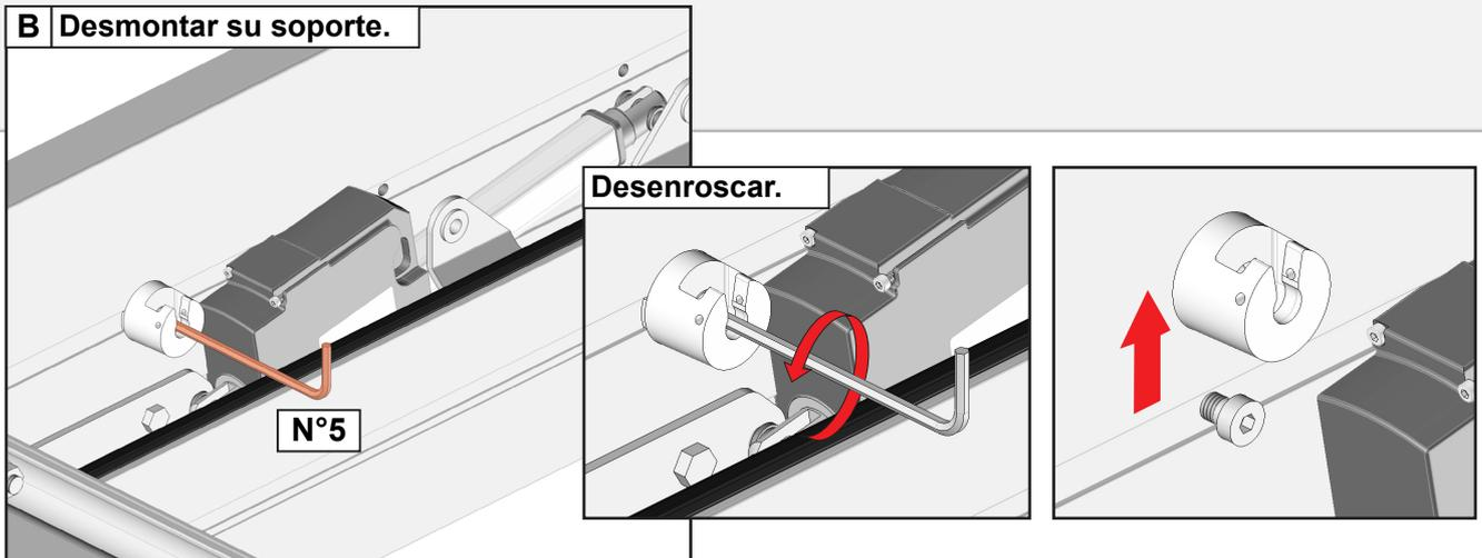
**4 Desenroscar completamente el tornillo del pistón.**
