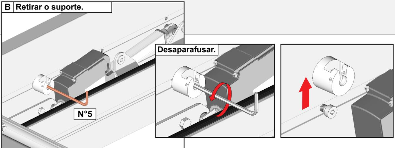
**4 Desapertar completamente o parafuso do macaco.**
