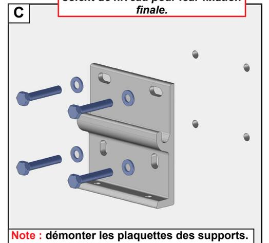
Note : démonter les plaquettes des supports.
