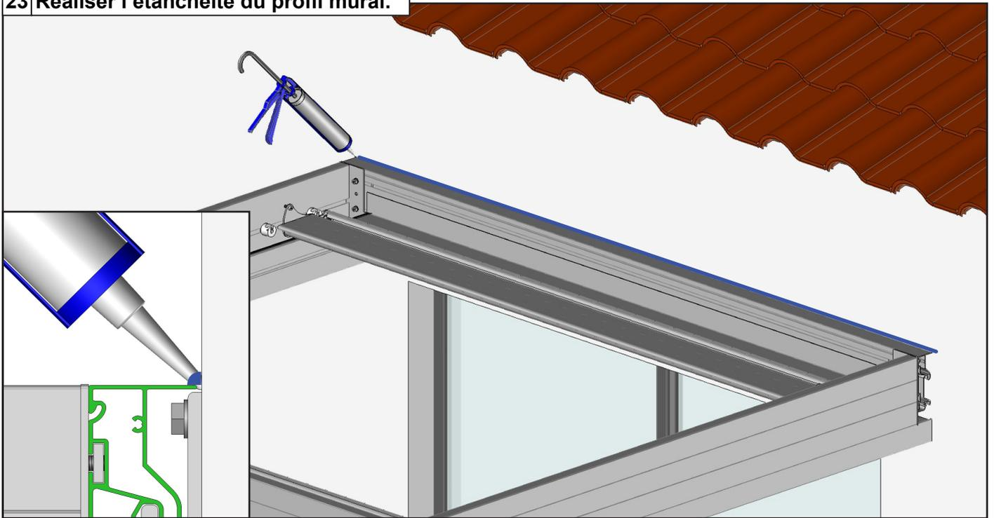
**24 Réaliser l'étanchéité. Pergola double travée et travée multiple.**
