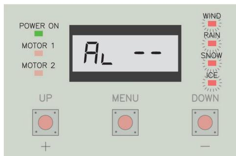
Lorsque la communication avec le capteur météorologique est perdue, la centrale met les moteurs en position de sécurité 33%. Dans cet état, aucune commande utilisateur n'est activée.
