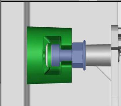
**IMPORTANT** : les vis de verrouillage se posent seulement au niveau de la lame centrale. Les lames restantes ne reçoivent pas la vis de verrouillage.
