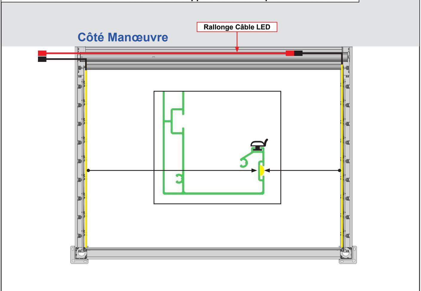
Pose des rubans de LED sur le coffre avant. Option LED seulement.
