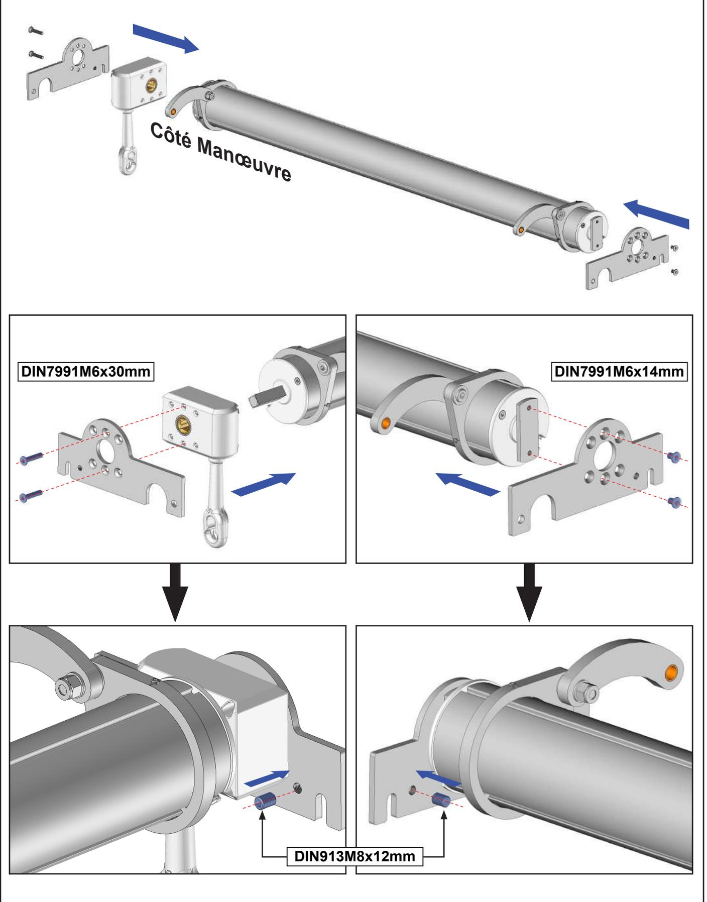
16 Pose du tube de manœuvre. Version treuil.
