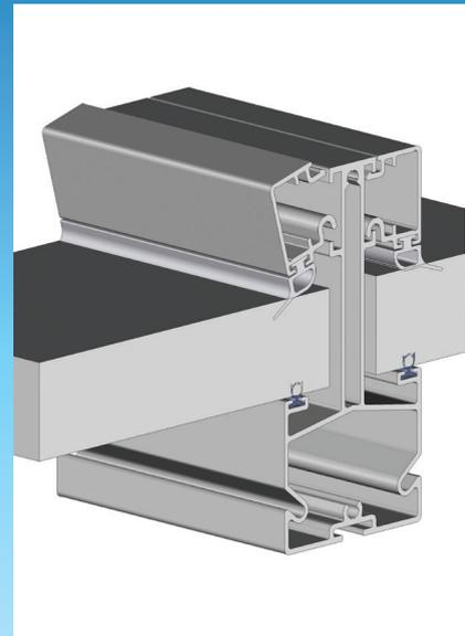
Clipsar los perfiles de bloqueo de las placas.
