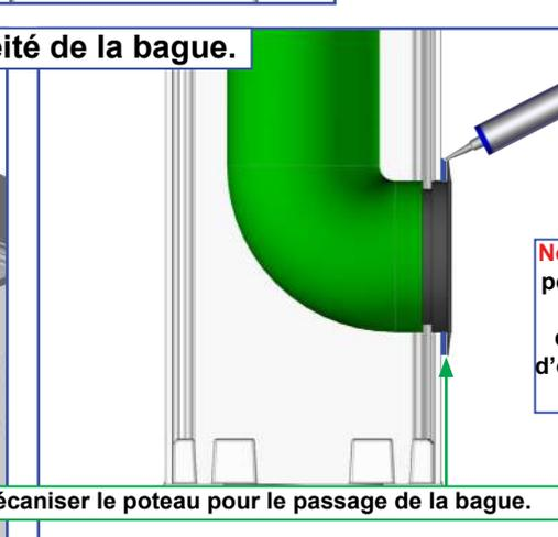
**Note :** l'évacuation sur poteau peut être orientée selon votre choix. Choisissez la face du poteau à mécaniser afin d'obtenir l'orientation de l'évacuation désirée.
