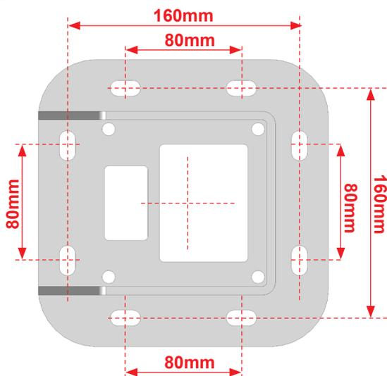
Fixez les platines au niveau de chaque plot béton réalisé. Utilisez un nombre de vis égal au nombre de trous de fixation présents sur la platine.
