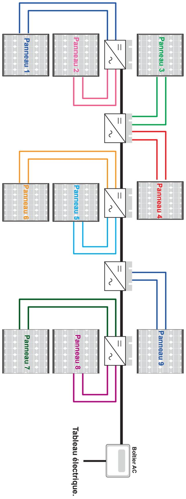
Schémas de principe 6KW : **ATTENTION**, connectez 4 micro-onduleurs maximum par entrée AC du boîtier AC 6 KW. Maxi 5 MO par entrée AC.
