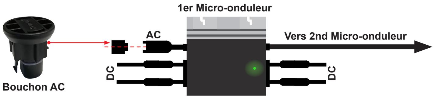
**Attention, les bouchons MC4 sont utilisés sur les kits de panneaux impairs seulement.**
