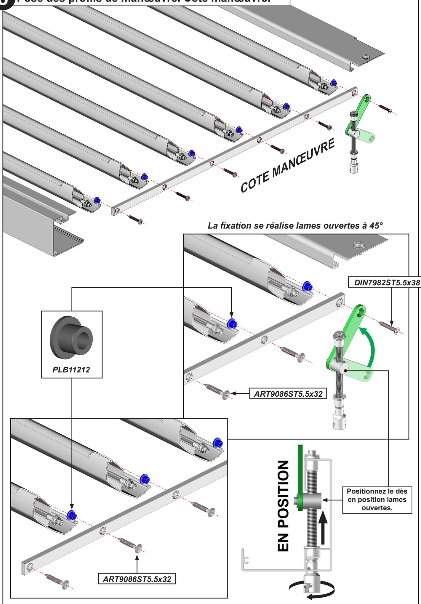
**9** Pose des profils de manœuvre. Côté opposée à la manœuvre.
