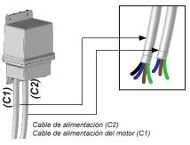
Especificaciones técnicas del mando a distancia por radio Tensión: 230 voltios Frecuencia: 50 Hz Potencia nominal: 1,5va Grado de protección: IP65 MOTOR: 230v - 50 H 500 w max Fijación: 4 tornillos Ø2,5 mm. La caja debe fijarse verticalmente y protegerse de la intemperie.
