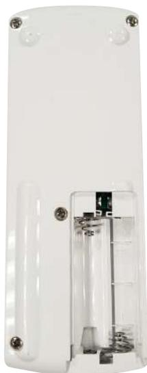
Ouvrez le boîtier de la télécommande, remplacez les piles en respectant la polarité + et -. Refermez le boîtier de la télécommande.
