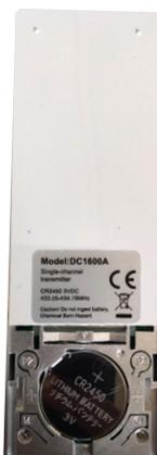
Ouvrir le boîtier de la télécommande, remplacer la pile en respectant la polarité + et -. Refermer le boîtier de la télécommande.
