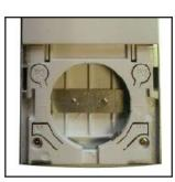
Abra la caja del mando a distancia y cambie la pila, respetando la polaridad + y -.
