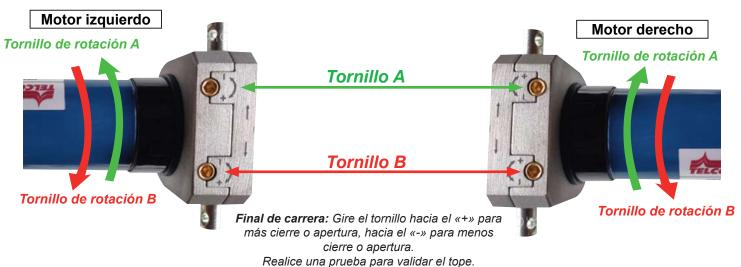
**Parada de cierre :** Asegúrese de que el motor se detiene al llegar al tope de cierre del Toldo para evitar la protección térmica.
